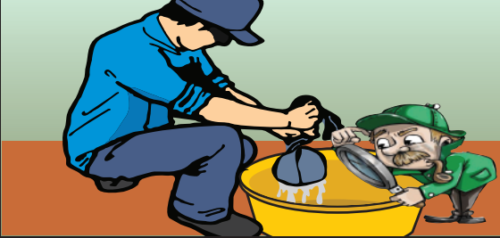
LA TELA DEJA ESCAPAR EL ORO ULTRAFINO JUNTO CON EL MERCURIO
